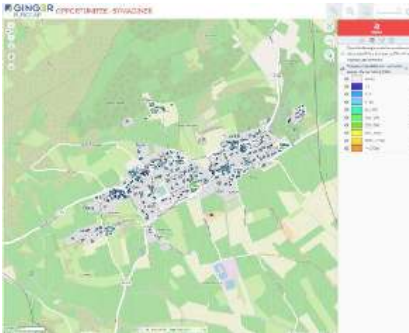
Figure 28 : Gisement solaire photovoltaïque sur ombrière, en injection (projets ayant un TRI supérieur à 4%) en MWc installables, Aspères – Source : OPPORTUNITÉ BURGEAP
